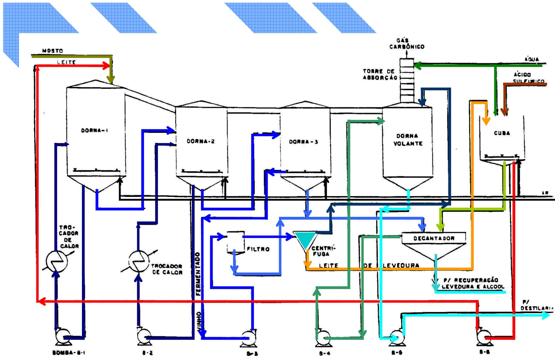
Figura 4 - Fluxograma do processo de fermentação contínua
