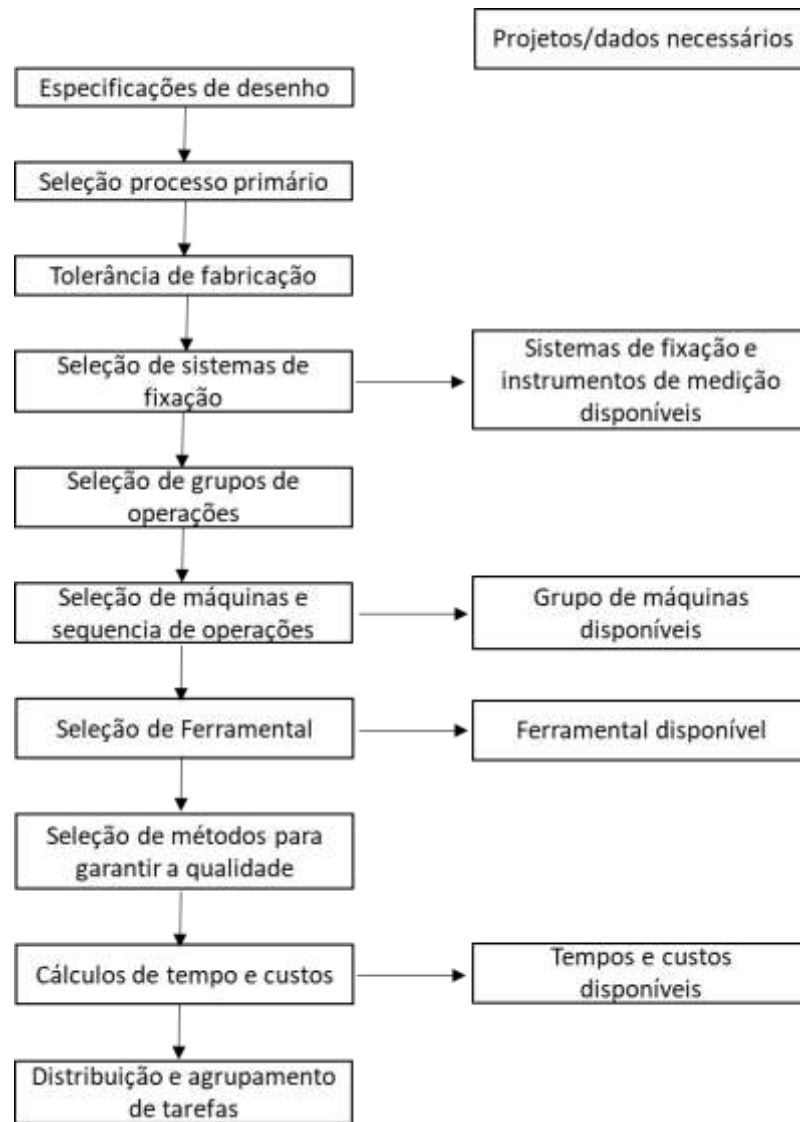
Figura 1 – Atividades típicas de uma seqüência de planejamento de processos para usinagem
