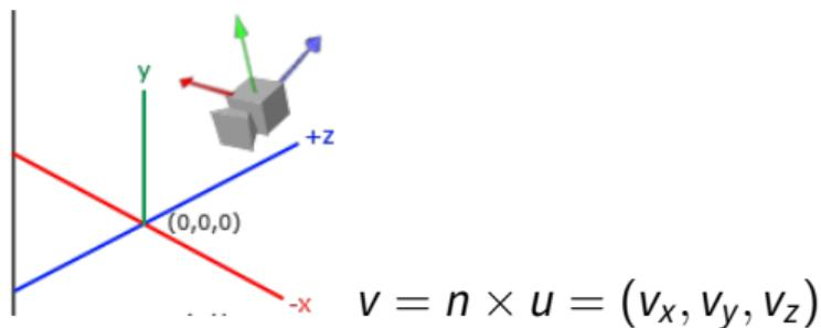
O vetor normalizado  $u$  é utilizado para obter o  $x_{\text{view}}$ . A partir de  $u$  e  $n$ , obtemos o  $y_{\text{view}}$ .
