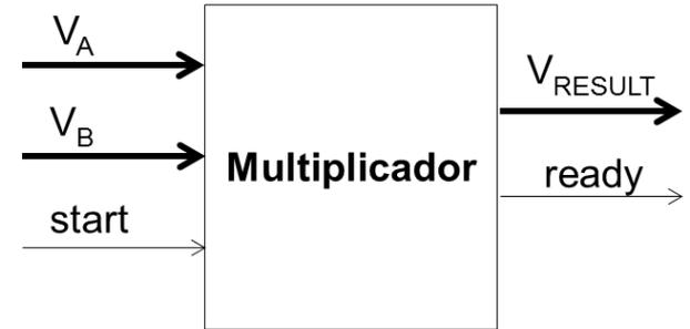
Para exemplificar, considere o projeto de um circuito multiplicador de dois números de 4 bits. O circuito recebe dois números através das vias  $V_A$  e  $V_B$ , ambas com 4 bits de largura, e começa a multiplicar esses dois números quando o sinal de START (via de 1 bit) vai para 1. Depois que a multiplicação termina (não se sabe a priori quanto tempo vai levar), o circuito multiplicador coloca o resultado na via de 8 bits  $V_{RESULT}$  e coloca o sinal READY em 1.
