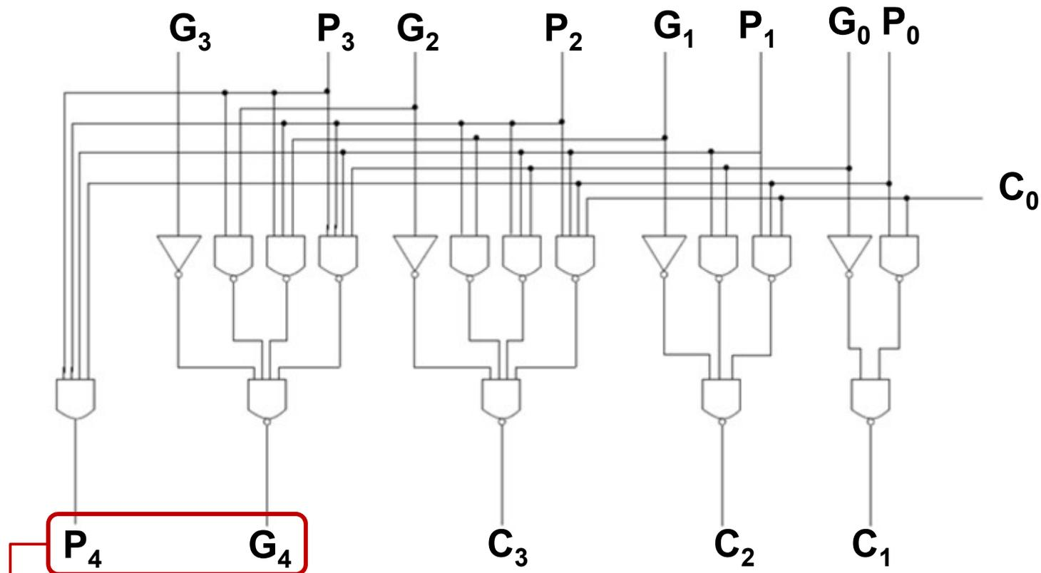
Podem ser usados para calcular  $C_4$  (útil para conectar blocos do tipo carry ripple) ou diretamente em um outro bloco de carry look-ahead
