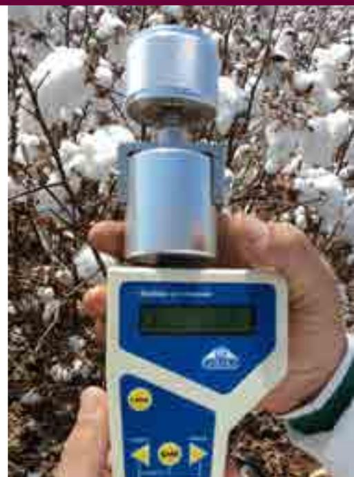
Figura 6. Umidímetro, aparelho que determina a umidade do algodão em caroço (Foto: Renato Bassini).
