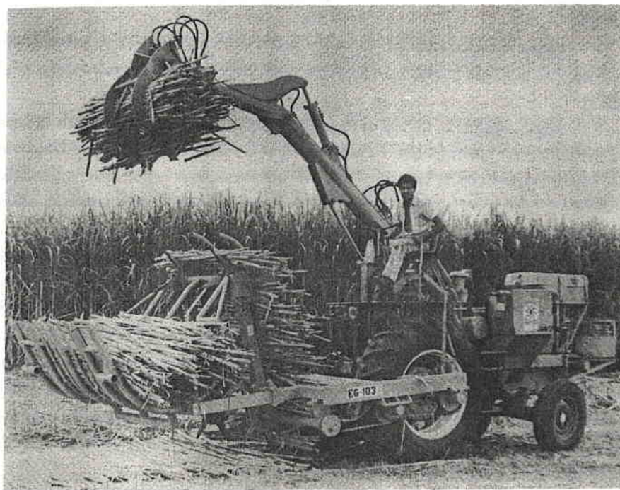
Figura 22. Carregadora contínua ("continuous loader") desenvolvida pela COPERSUCAR. (BRAUNBECK, foto).
