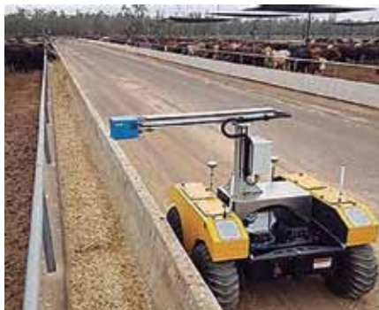
Dispositivo tipo scanner (radar), que acoplado a veículo, faz leitura de cocho.
