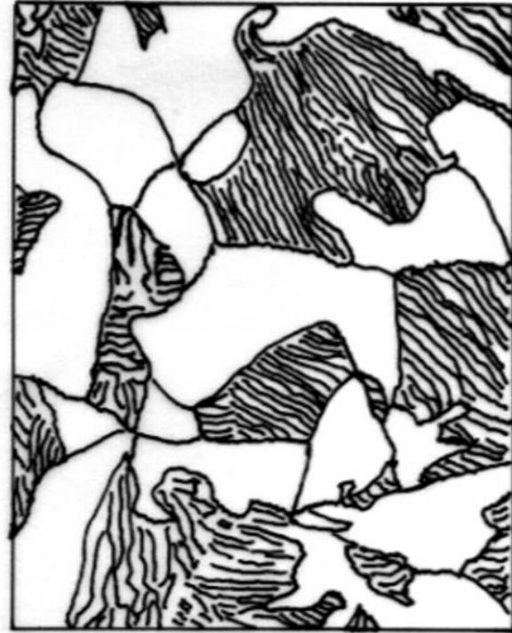
Microestrutura de um aço com 0,4% C
