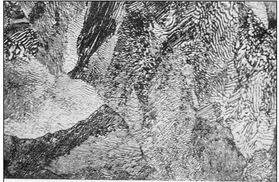
Fig. 287 — Aço eutetóide. Grãos de perlita. Ataque: nítrico. As áreas que aparecem confusas neste material apresentam-se, entretanto, nitidamente lamelares ao microscópio, girando o corpo de prova de  $90^{\circ}$  1000 x.
