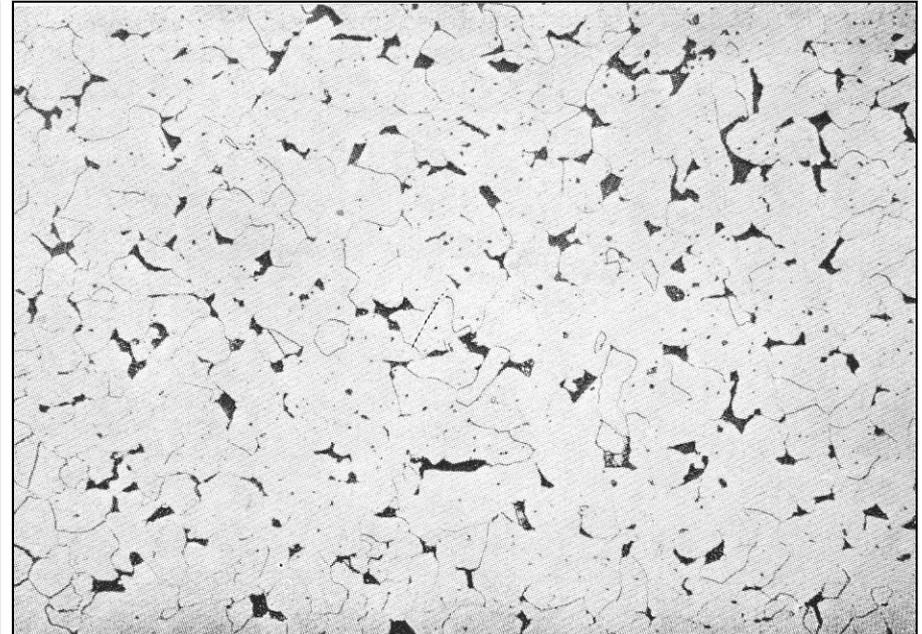
Fig. 281 — Aço com aproximadamente 0,1% de carbono esfriado lentamente. Grãos escuros de perlita e grãos claros de ferrita com numerosas pequenas inclusões. Ataque: pícrico. 160 x.
