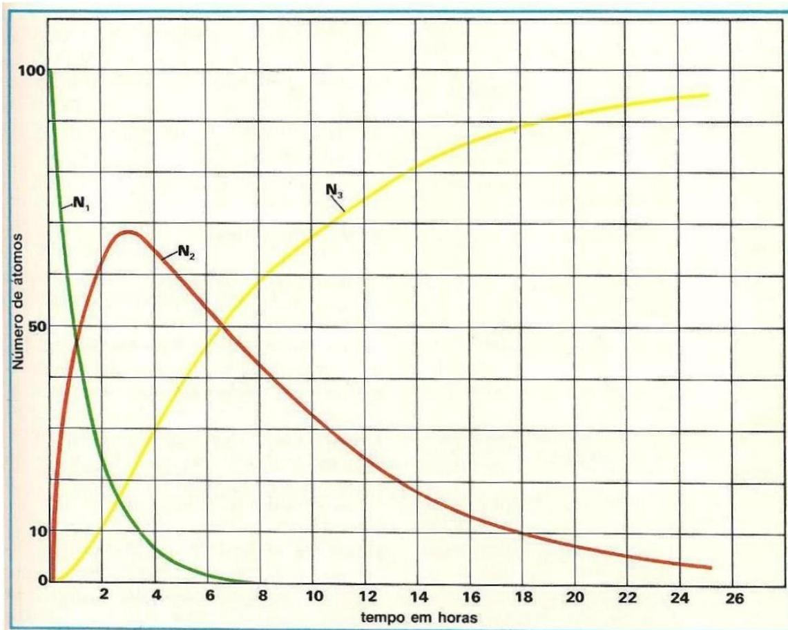
Figura 1 – Variação do número de núcleos (átomos) em uma série radioativa de três membros na qual o núcleo pai **1** possui meia-vida igual a 1 hora, o núcleo filho **2** possui meia-vida igual a 5 horas e o terceiro membro **3** é estável.
