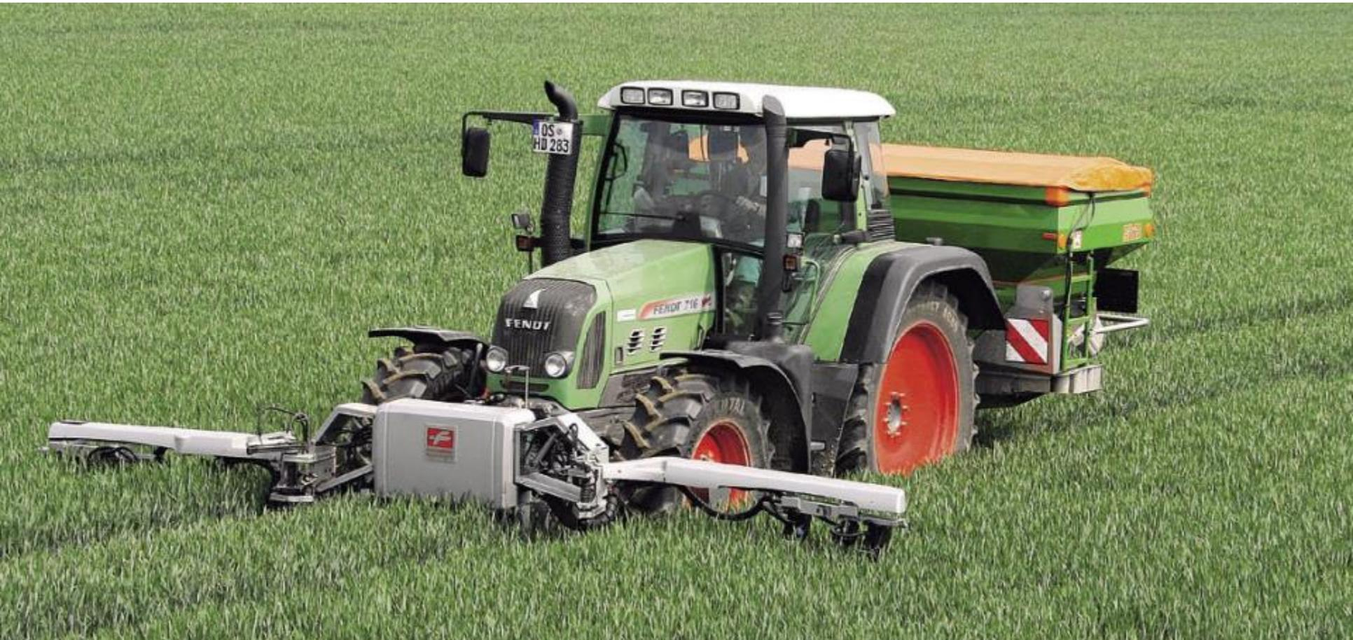
Facho de laser ‘illumina’ as folhas com um certo espectro e causa fluorescência na clorofila presente (LIF = laser induced fluorescence); o espectro da luz refletida é assim alterado.
