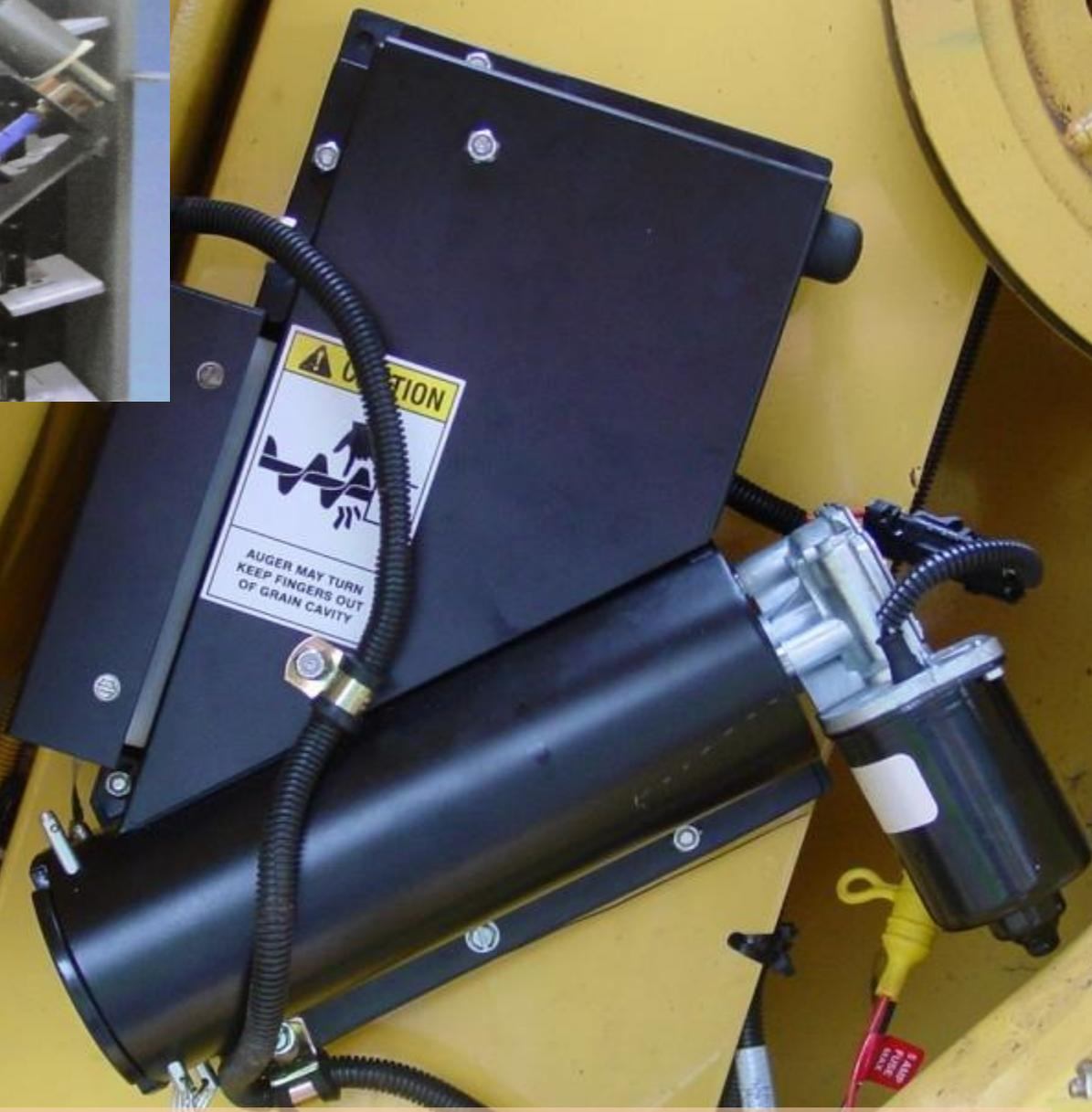
Sensores de umidade dos grãos
