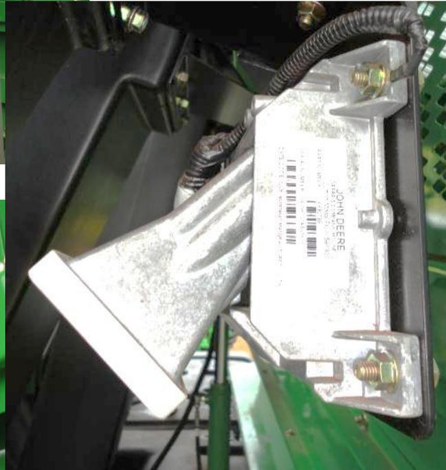
Sensor de microondas
