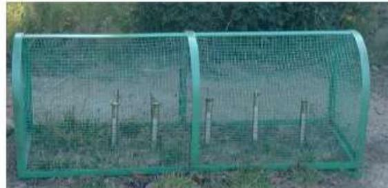
Geotermômetros instalados em solo desnudo
