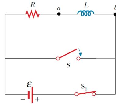
Ligando-se a chave S com a chave S1 ainda ligada, a fonte será colocada em curto forçando a parada da corrente. Isto gerará uma alteração no fluxo magnético no indutor, gerando uma fem induzida:
