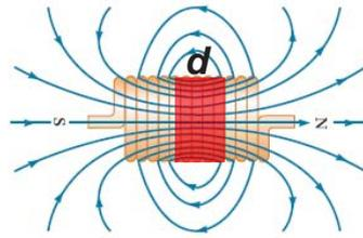
Tomemos um comprimento  $d$  próximo ao centro do solenóide.
