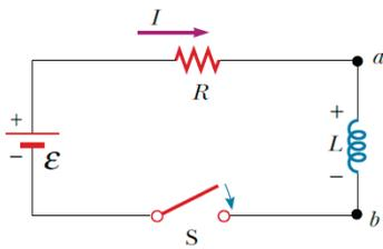
No início, o indutor se oporá à passagem de corrente em decorrência da variação do fluxo magnético. Isso gerará uma força eletromotriz induzida  $\varepsilon_{\text{ind}}$ , ou uma queda de potencial  $V_L$ :
