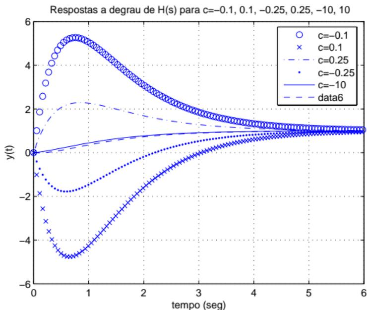
Figura: Respostas a degrau do sistema  $H(s)$  para diferentes valores de  $c$ .
