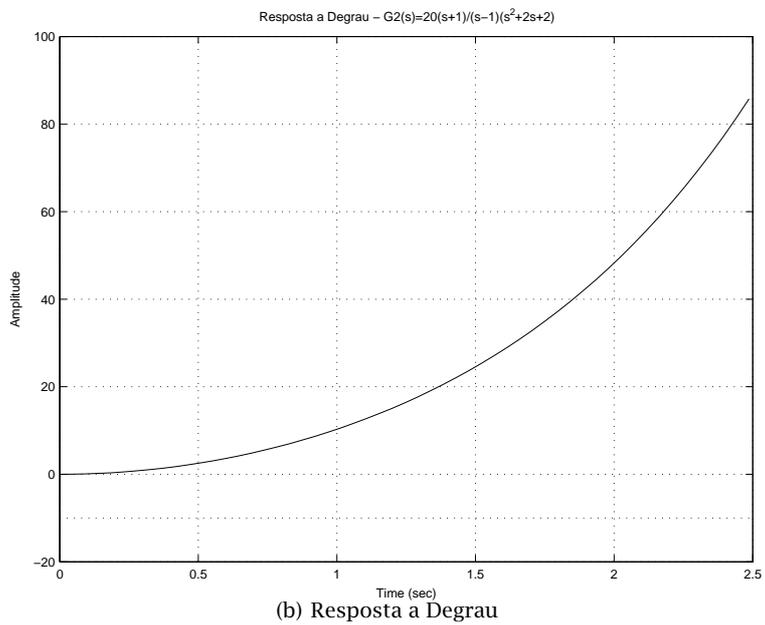
**Figura 2.3.** Comportamento do sistema  $G_2(s)$ .
