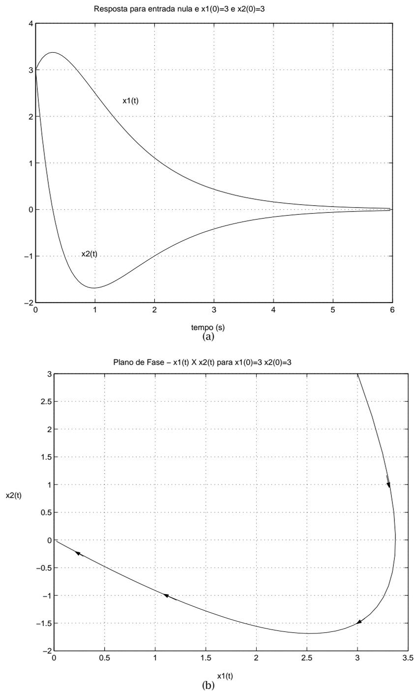
**Figura 2.1.** (a) Evolução de  $x_1(t)$  e  $x_2(t)$  em função do tempo - (b) Trajetória do sistema para entrada nula e condições iniciais  $x(0)$  no espaço de estados (plano de fase).
