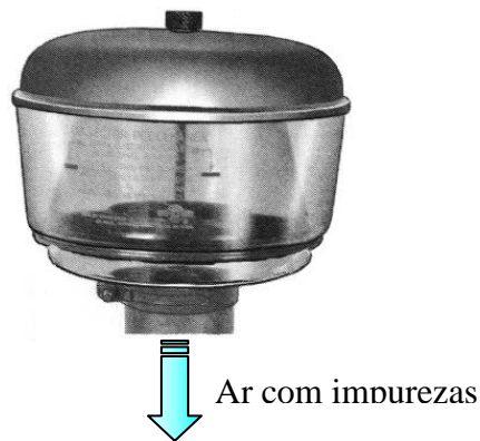
Figura 9. Pré-filtro do circuito de ar do sistema de alimentação.
