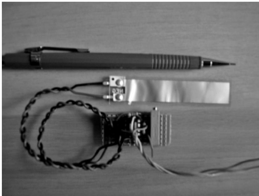
FIGURA 16.3.4 Filme piezoelétrico com circuito tipo *buffer*.
