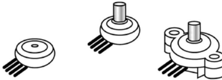
FIGURA 12.24 Diferentes encapsulamentos de sensores de pressão.
