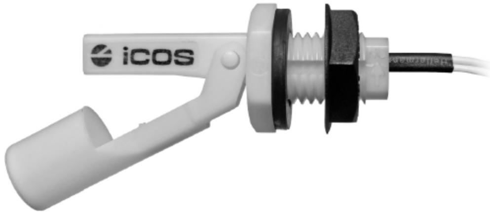
**FIGURA 13.6** Fotografias de detectores comerciais de nível com chaves que utilizam uma boia, um ímã interno e um *reed-switch*. (Cortesia de Icos Excetec Ltda.)
