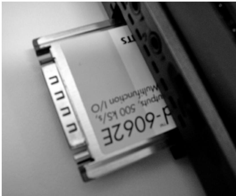
**FIGURA 16.7.1** Foto em que se vê a placa ADC DAQ6062E instalada em um computador de propriedade dos autores. (Cortesia de National Instruments Corporation.)
