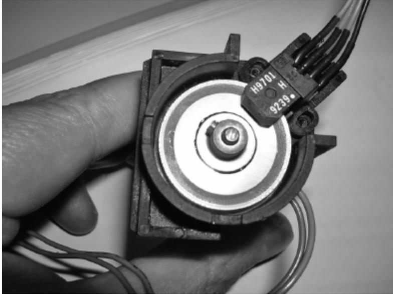
FIGURA 16.10.2 Motor DC com o eixo acoplado ao disco do *encoder* óptico. Nesse *encoder*, o disco apresenta traços impressos em uma base transparente.
