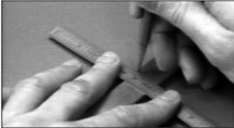
**FIGURA 10.43** Procedimento de traçado da peça. (Cortesia de Vishay Intertechnology, Inc.)
