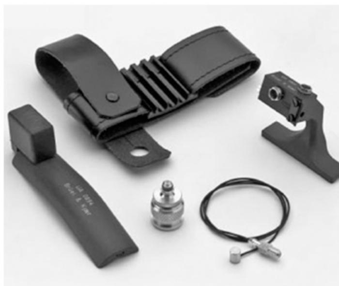
**FIGURA 11.140** Conjunto de dispositivos para medição da vibração no segmento mão-braço: acelerômetro, cabos e dispositivos de fixação. (Cortesia de Brüel&Kjaer.)
