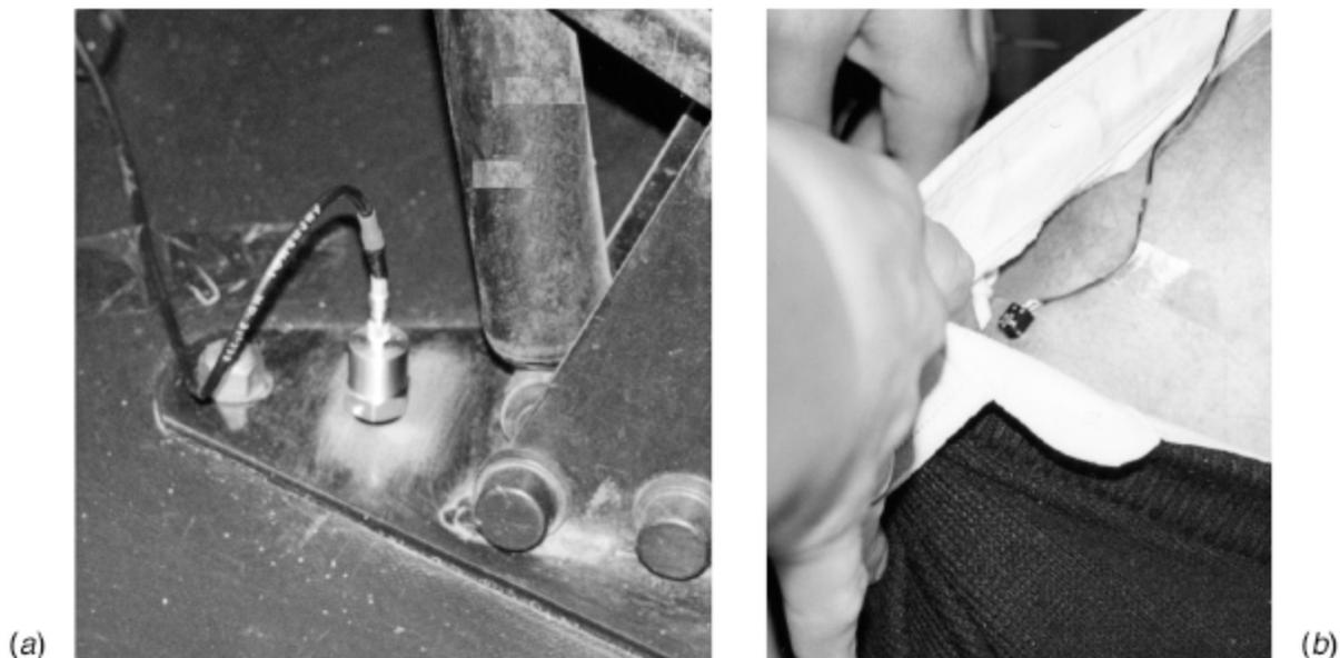
**FIGURA 11.92** Fotos de duas aplicações baseadas em acelerômetros: (a) caracterização da vibração em chassi de um veículo (percebe-se que a área sob o acelerômetro foi tratada e limpa, tornando-a adequada para a fixação do acelerômetro com rosca apropriada) e (b) estudo da vibração humana (microacelerômetro fixado com fita de dupla face para estudo da transmissibilidade da vibração no segmento mão-braço-trapézio).
