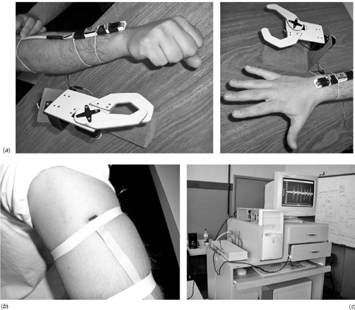
**FIGURA 11.111** Fotos de aplicações dos acelerômetros iMEMS: (a) sistema protótipo utilizando acelerômetro e eletrogoniômetro para determinar a rotação do punho e a inclinação do braço; (b) detalhe da fixação provisória do acelerômetro; e (c) sistema utilizado para adquirir, analisar e caracterizar o deslocamento, a velocidade e a aceleração de um determinado movimento.
