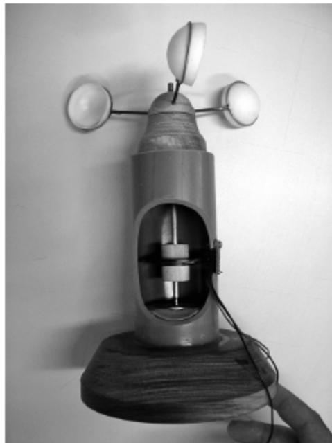
FIGURA 16.10.4 Anemômetros construídos com um *encoder* óptico.
