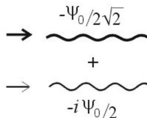
6) Mudança no sentido de propagação, por exemplo ao refletir perpendicularmente em um espelho, formando ondas estacionárias. Neste caso, é preciso representar as ondas de forma mais completa. Para a onda incidente  $\psi_I(x,t) = \psi_0 e^{i(kx - \omega t + \phi)}$ , tem-se a amplitude refletida  $\psi_R(x,t) = \psi_0 e^{i(kx + \omega t - \phi)}$ , cuja soma fornece a onda estacionária:  $\psi_I(x,t) + \psi_R(x,t) = 2\psi_0 \cos(\omega t) \sin(kx)$ .
