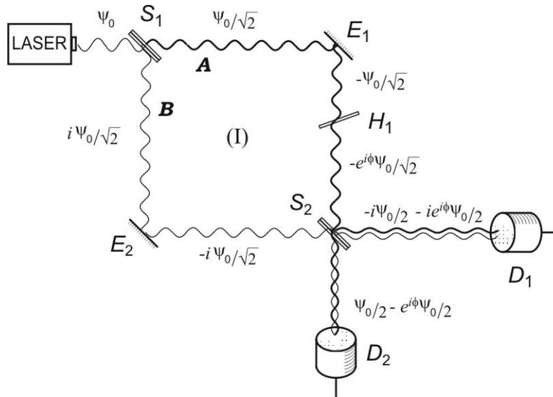
Figura V.1. Interferômetro de Mach-Zehnder, com as amplitudes clássicas em cada trecho.
