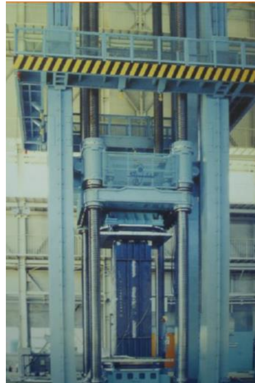
Ensaio de compressão em colunas de aço
