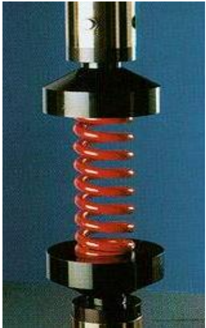
Ensaio de compressão em molas para verificação da constante elástica e da resistência
