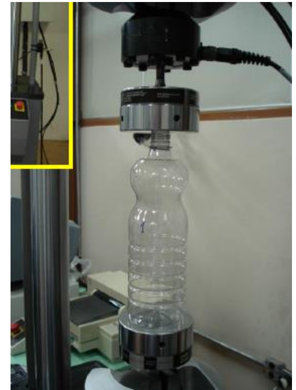
Ensaio de compressão em garrafas pet
