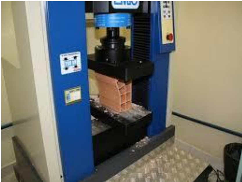
Ensaio de compressão em tijolos, lajotas e blocos
