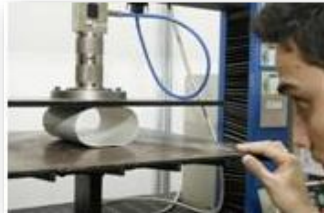
Ensaio de compressão em tubos (achatamento e amassamento)
