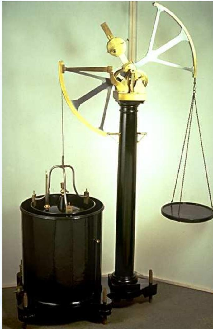
Deux grands gazomètres pour réaliser l'expérience de la synthèse de l'eau. Avec ces balances de précision, il pèse les deux gaz -- hydrogène et oxygène -- qu'il introduit ensuite dans un ballon pour les recomposer grâce à une étincelle électrique et obtenir ainsi quelques grammes d'eau. Il démontrera ainsi la loi de conservation des masses.
