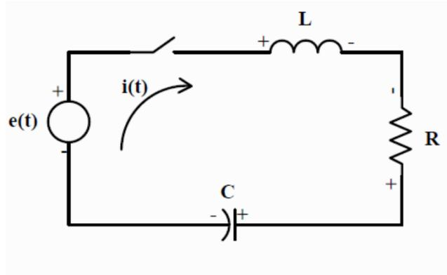
*Problema:* Dado o sinal de entrada,  $v(t)$ , e o sinal de saída  $v_C(t)$ , tensão no capacitor, construa a modelagem desse circuito no espaço de estados.
