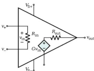
Quanto menor for a resistência interna **R<sub>i</sub>**, maior a corrente drenada na entrada do amp-op, o que modificaria o ganho previsto no circuito com o amp-op ideal.
