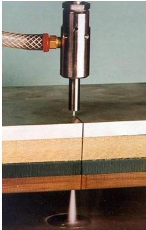
Figura 3.1 – Usinagem com jato de água cortando diferentes materiais.
