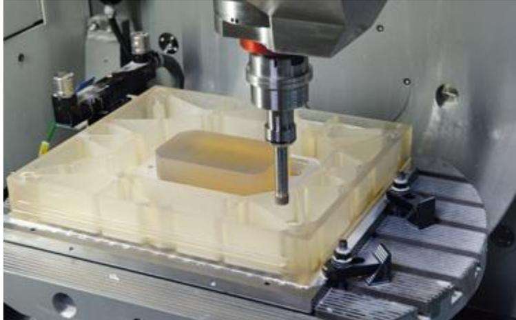
Figura 6 – Exemplo de usinagem por ultrassom
