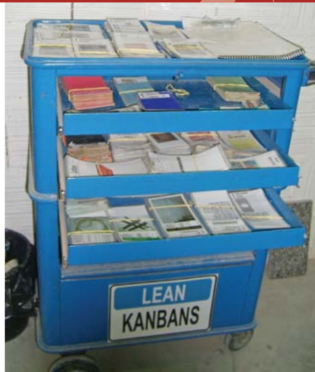
Caixa de Kanbans na administração da obra
