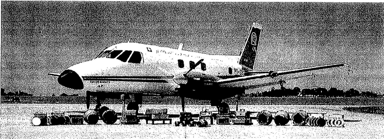
Fig. 1.5 Aeronave EMB-110 BANDEIRANTE (do INPE) e seus principais sensores remotos. No detalhe está a câmara fotográfica instalada na parte inferior do avião que voa em faixas, de um lado ao outro da área a ser fotografada, a intervalos regulares, e dispara a câmara fotográfica automaticamente. Fotos: Carlos Alberto Steffen.
