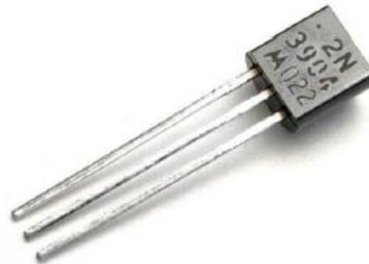
Figura 2.12: Componente 2N3904: transistor NPN com encapsulamento TO-92
