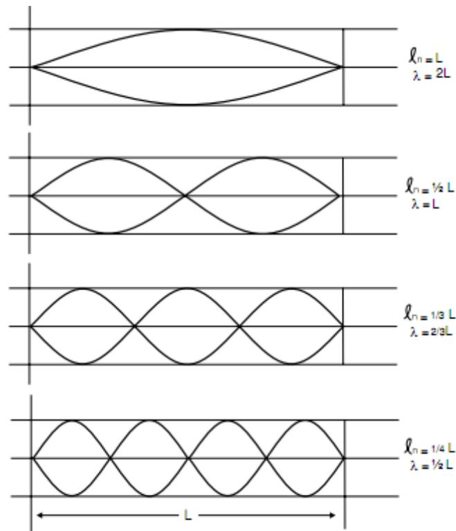
Figura 3 - Figura mostrando os quatro primeiros harmônicos de uma corda fixa nos extremos.
