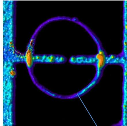
Os anéis posicionados em eletrodos metálicos permitem estudar fenômenos de transporte elétricos novos => desenvolver novas tecnologias de dispositivos (imagem obtida pela IBM)
