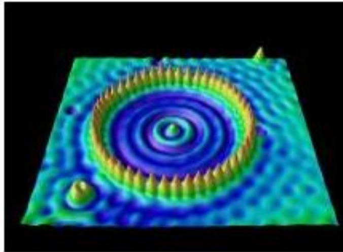
Pesquisadores da IBM – Arrastaram átomos de ferro na forma circular em uma superfície de cobre, fazendo com que a maioria dos elétrons da superfície fossem armadilhados, criando ondas estacionárias uniformes dentro do círculo.
