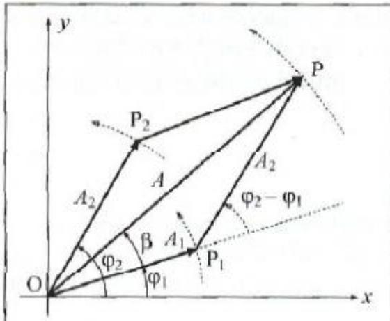
$$x(t) = x_1(t) + x_2(t) \quad \begin{cases} x_1(t) = A_1 \cos(\omega t + \varphi_1) \\ x_2(t) = A_2 \cos(\omega t + \varphi_2) \end{cases}$$
