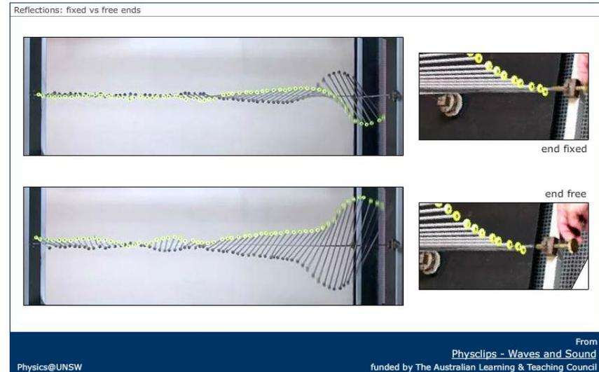
No apparatus com extremidade fixa ocorre a inversão do pulso
