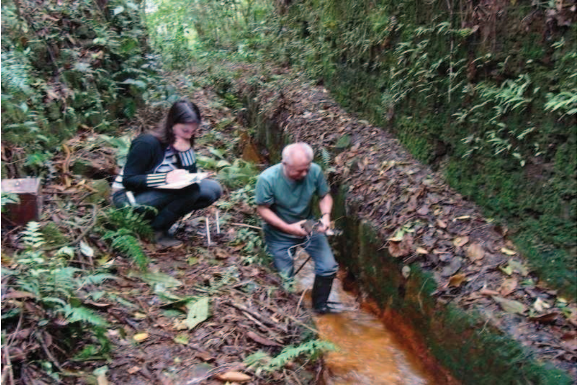
Figura 25: Medida de vazão da mina Poeira utilizando molinete. (Fonte: AMARAL, 2009)
