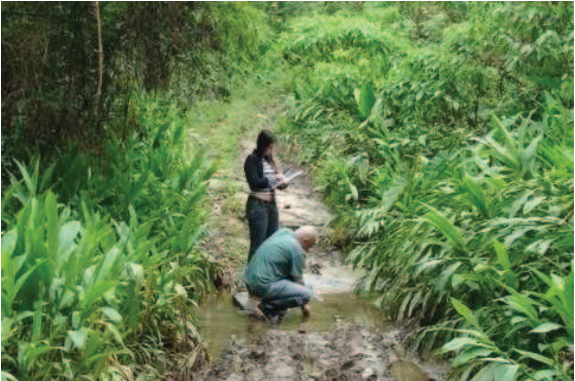
Figura 26: Medida de vazão do córrego a montante da BM 01 utilizando micro molinete. (Fonte: AMARAL, 2009)
