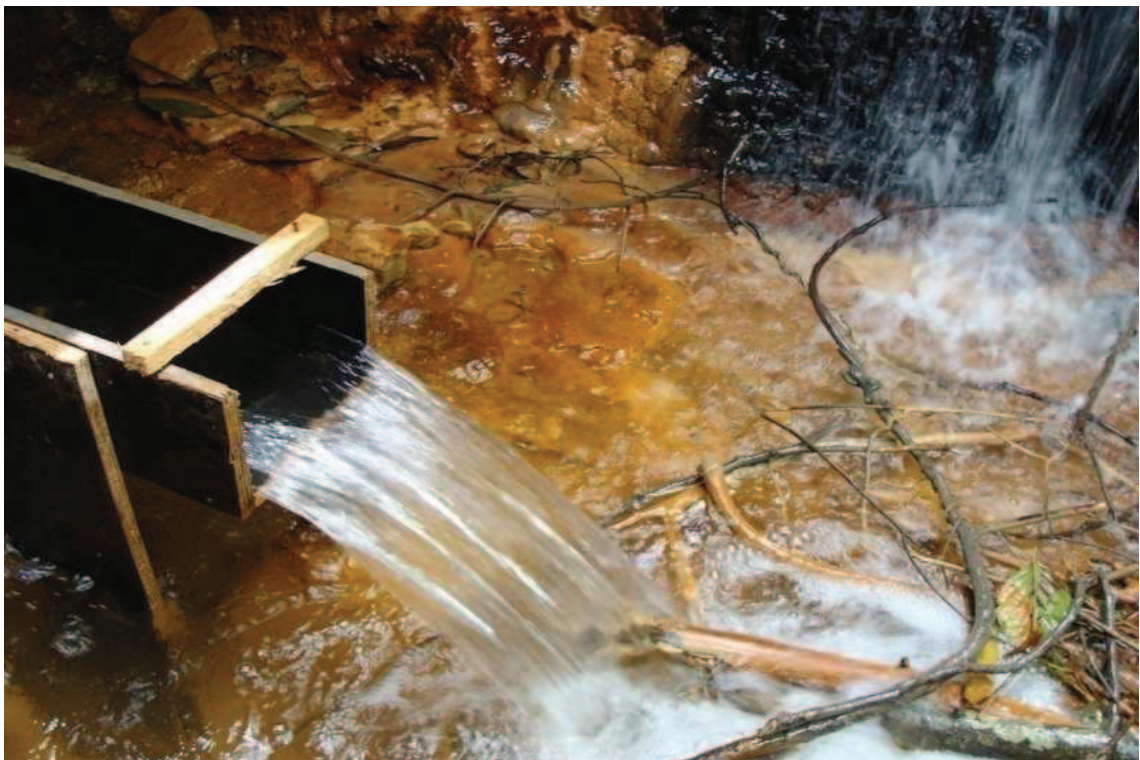
Figura 24: Calha utilizada para medida de vazão da mina Poeira. (Fonte: CANCELIER, 2009)
