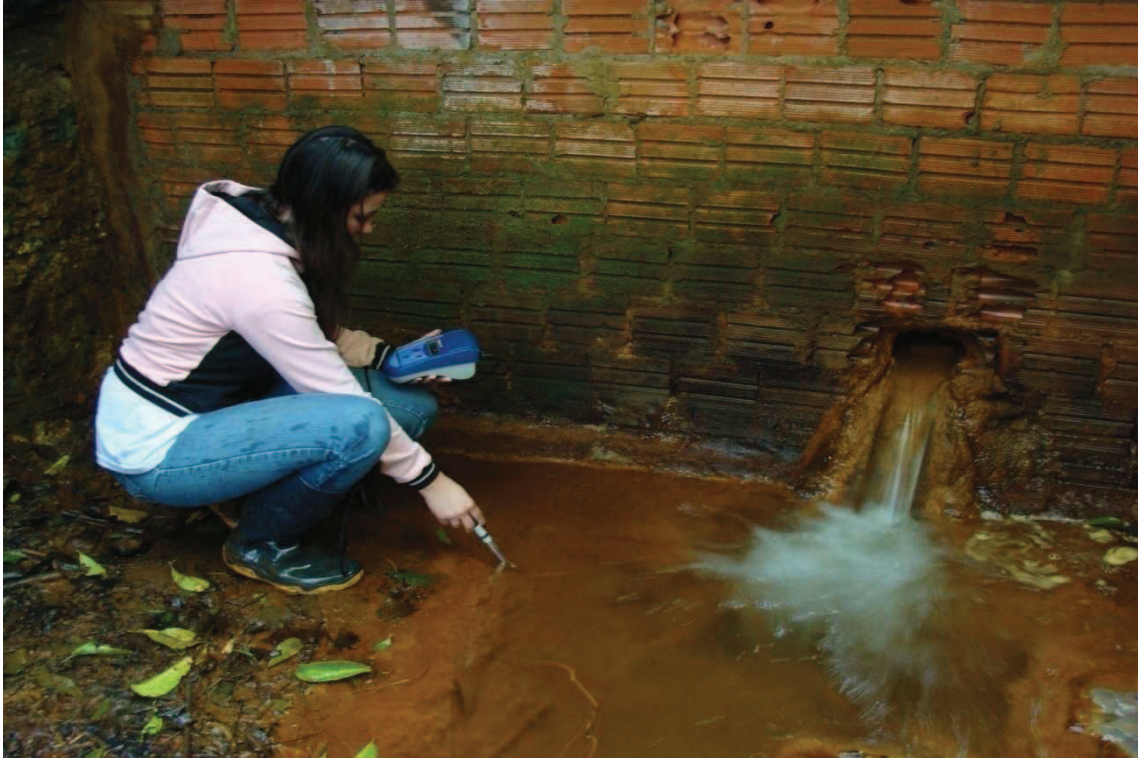
Figura 28: Medição da condutividade elétrica e temperatura da DAM. (Fonte: AMARAL, 2009)
