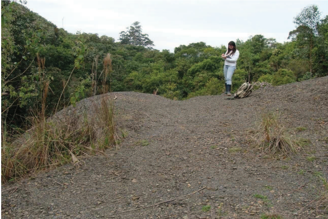
Figura 20: Depósito de rejeito carbonoso proveniente das BMs localizadas no perímetro da área 13 A. (Fonte: AMARAL, 2009)
