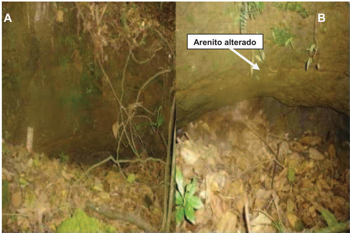
Figura 30: A → Localização da BM 02 evidenciando as rochas da cobertura. B → Detalhe da alteração do arenito de cobertura e obstrução da boca da mina. (Fonte: CANCELIER, 2009)
