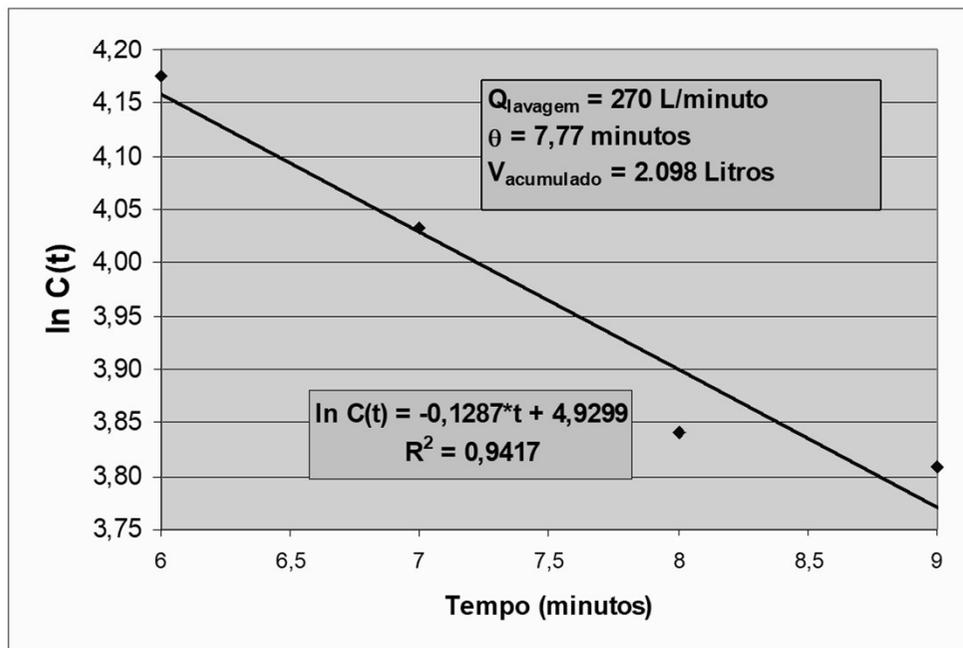
**Linearização dos dados obtidos nos ensaios de lavagem dos reatores.**
