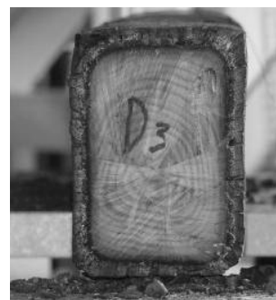
Figura 5.4 - Carbonização da madeira
