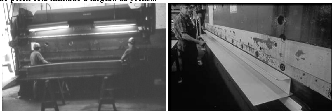
Figura 3.4 – Fabricação de perfis formados a frio empregando dobradeira
