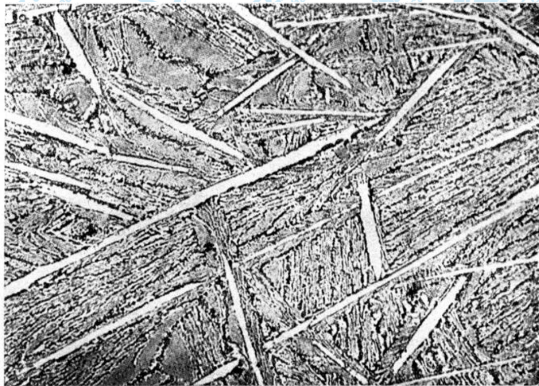
Fig. 528 — Ferro fundido branco hipereutético. Longos cristais de cementita sobre um fundo de ledeburita. Ataque: pícrico. 150 x.
