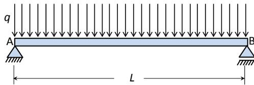
A viga biapoiada da figura tem comprimento  $L$  e está submetida a uma carga distribuída uniforme  $q$ . A seção transversal da viga é o perfil  $T$  invertido esquematizado na figura. Pede-se determinar a máxima tensão de tração e a máxima tensão de compressão a que a viga está submetida.
