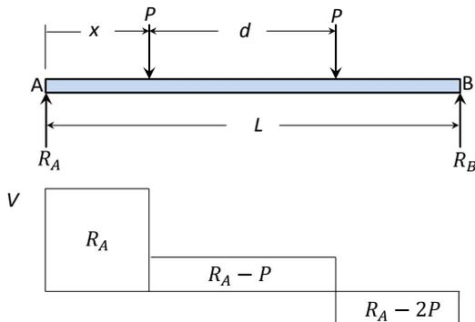
Ou seja, a máxima força cortante, em módulo será  $R_A$  ou  $R_A - 2P$  ( $R_B$ ), mas como o problema é simétrico, basta analisar um dos dois valores. Da expressão obtida acima, o valor máximo de  $R_A$  ocorrerá para  $x = 0$ . Então:
