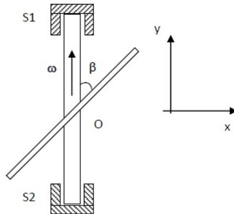
(0,7) (a) Calcule o momento de inércia da barra em torno de eixo de rotação  $S1 - S2$  (dica: use a coordenada  $y$  (vertical) como a variável de integração);
