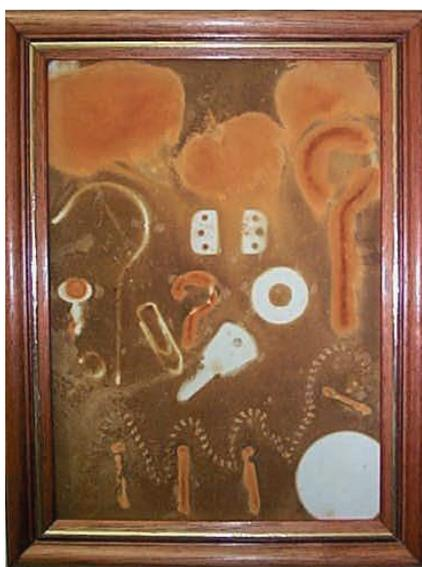
Figura 5: A- Palha de aço, prego, corrente, chave, gancho de cabide, trinco, clipe, arruela e solução de permanganato de potássio. B- Ralo de banheiro, cliques, pregos, buchas e solução de permanganato de potássio.
