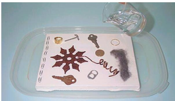
3. A solução de vinagre é vertida lentamente sobre os metais e a tela é deixada em repouso por um período de três dias. Em seguida, os metais são retirados e a tela é mantida à temperatura ambiente, por um período de dois dias, para secagem.
