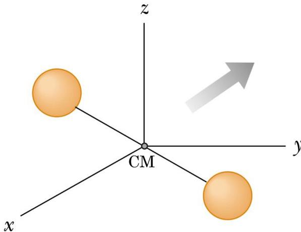
**Movimento de translação:** O centro de massa da molécula pode transladar nas três direções:  $x$ ,  $y$  e  $z$  (três graus de liberdade)  $\Rightarrow$  energia cinética de translação da molécula
