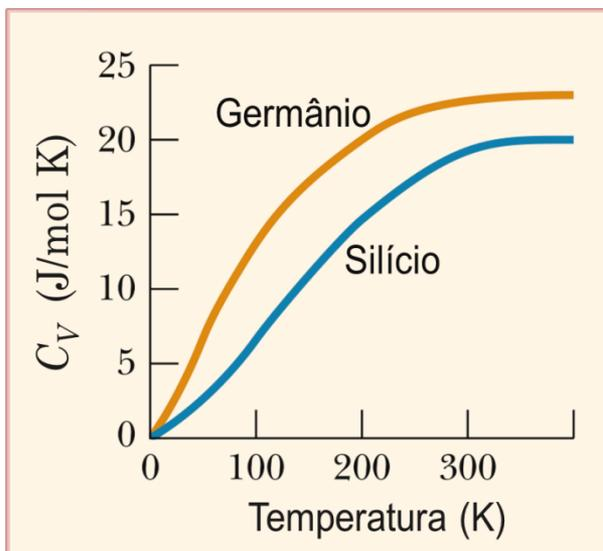
equilíbrio, cada átomo executa um MHS em torno das direções  $x$ ,  $y$  e  $z$ . Associando dois graus de liberdade de vibração para cada direção, temos 6 graus de liberdade, cada um contribuindo com  $\frac{1}{2}kT$ , levando à  $C_V = 3R$ , de acordo com a lei de Dulong-Petit. Uma explicação para as discrepâncias, para baixas temperaturas, só veio a ser fornecida pela mecânica quântica, com a quantização da energia dos OH (fônons).
