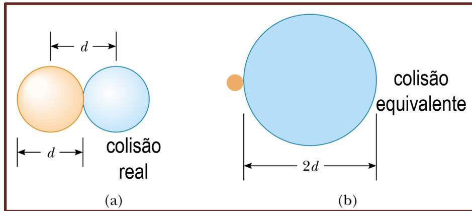
No tempo  $t$ , uma molécula com velocidade média  $\bar{v}$ , percorre uma distância  $\bar{v}t$ . Nesse mesmo intervalo de tempo, a molécula equivalente de diâmetro  $2d$ , varre o volume de um cilindro de área transversal  $\pi d^2$  e comprimento  $\bar{v}t$ . ( $\sigma = \pi d^2 \rightarrow$  seção de choque)
