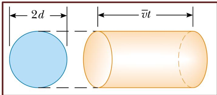
Se o número de moléculas por unidade de volume for  $n_V$ , então o número de moléculas no cilindro é  $(\pi d^2 \bar{v}t) n_V$  e a molécula equivalente de diâmetro  $2d$  colide com todas as moléculas contidas no cilindro no intervalo de tempo  $t \Rightarrow$  número de colisões no tempo  $t$  é  $(\pi d^2 \bar{v}t) n_V$ .
