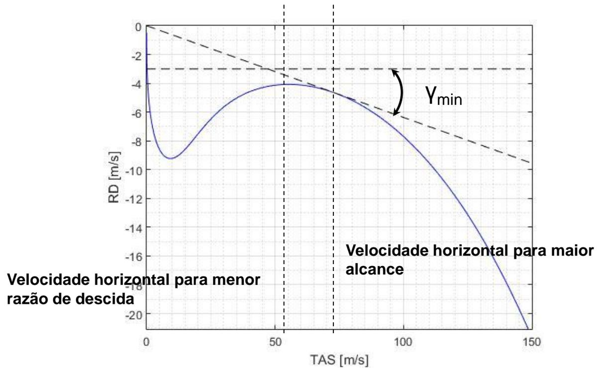
A condição de maior alcance ocorre para o menor arrasto, já a condição para menor razão de descida ocorre na condição de menor potência necessária ( $V \approx 0.76V_{Emax}$ )
