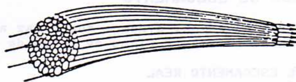
FIGURA 3.3 - Tubo de escoamento.
