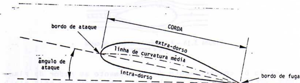
FIGURA 3.16 - Geometria do Perfil aerodinâmico.
