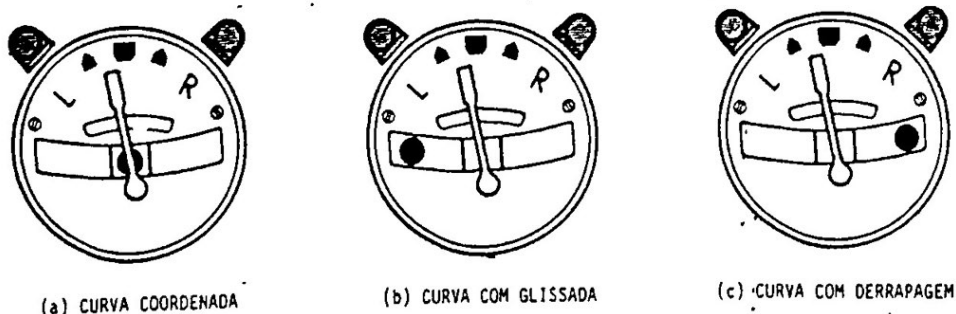
FIGURA 13.19 - Indicações do indicador de curva, derrapagem e glissada.
