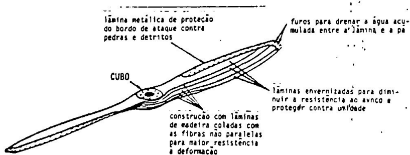
FIGURA 8.4 - Hélice de madeira.
