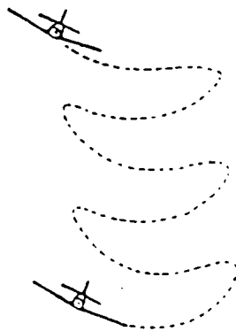
FIGURA 6.38 - Avião dinamicamente indiferente.
