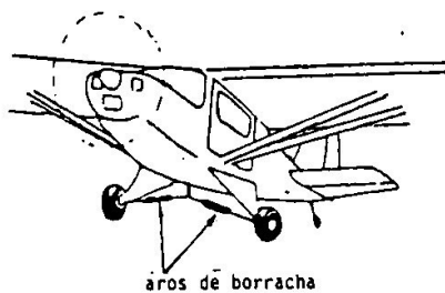
FIGURA 12.44 - Trem de pouso com amortecimento através de anéis de borracha.
