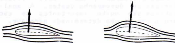
FIGURA 3.29 - A influência da espessura do perfil.
