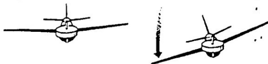
FIGURA 13.12 - Comportamento do giroscópio com relação ao movimento de rolamento de um avião.
