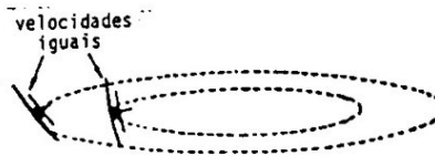
FIGURA 10.27 - A influência do raio de curvatura da trajetória sobre a inclinação lateral do avião.
