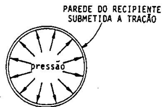
FIGURA 12.8 - Cilindro com pressão interna.
