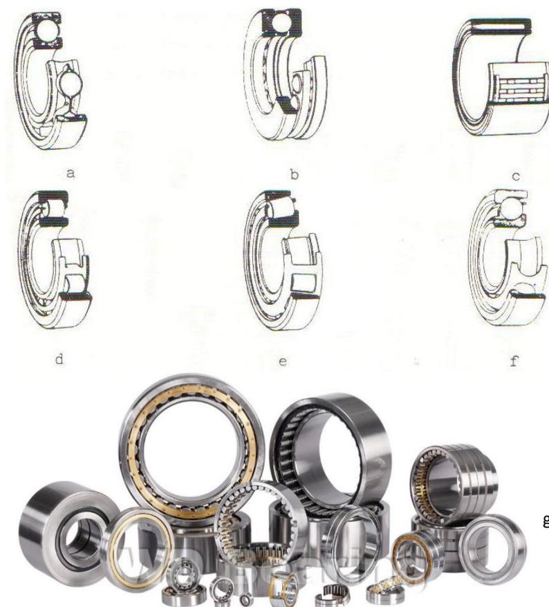
Figura 17. Mancais de rolamento radial de esferas (a); axial de esferas (b); de agulhas (c); de rolos cilíndricos (d); de rolos cônicos (e); contato angular de esferas (f); coletânea de rolamentos (g)
