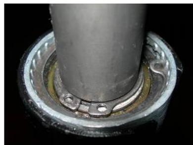
Figura 21. Diferentes tipos de anéis elásticos e sua utilização
