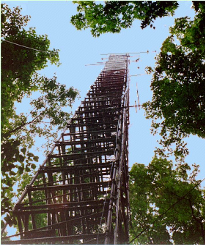
**Sistemas de Eddy-covariância** medem a direção tridimensional do vento e da concentração de gases.
