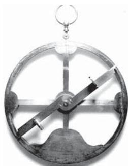
O astrolábio náutico já era um instrumento mais complexo, de madeira ou latão, usado sobretudo para determinação meridiana da altura do Sol, que podiam ser determinadas duma maneira indirecta. Assim era formado por um círculo, suspenso por uma argola. Tinha quadrantes graduados, de
