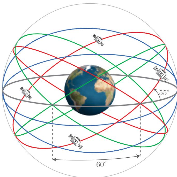
Figura 3.3: Representação esquemática das 6 órbitas praticamente circulares, cada uma com 4 satélites GPS (para não sobrecarregar a figura, só aparecem 4 satélites). Todas as órbitas estão na mesma altitude e são inclinadas em relação ao equador com ângulo de  $\approx 55^\circ$ . Os nodos das órbitas estão distribuídos em intervalos de  $60^\circ$  ao longo do equador celeste (o círculo cinza espesso).
