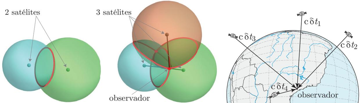
Figura 3.4: A intersecção de duas esferas é um círculo (em vermelho no painel a esquerda). A intersecção entre três esferas, se dá em 2 pontos. O usuário de um receptor GPS está em uma destas intersecções, captando o sinal de três satélites neste exemplo. O painel a direita mostra as pseudo-distâncias  $c\delta t_i$  de cada um dos 4 satélites necessários para determinar a posição do observador, onde  $\delta t$  é o intervalo de tempo que o sinal leva para chegar no receptor.
