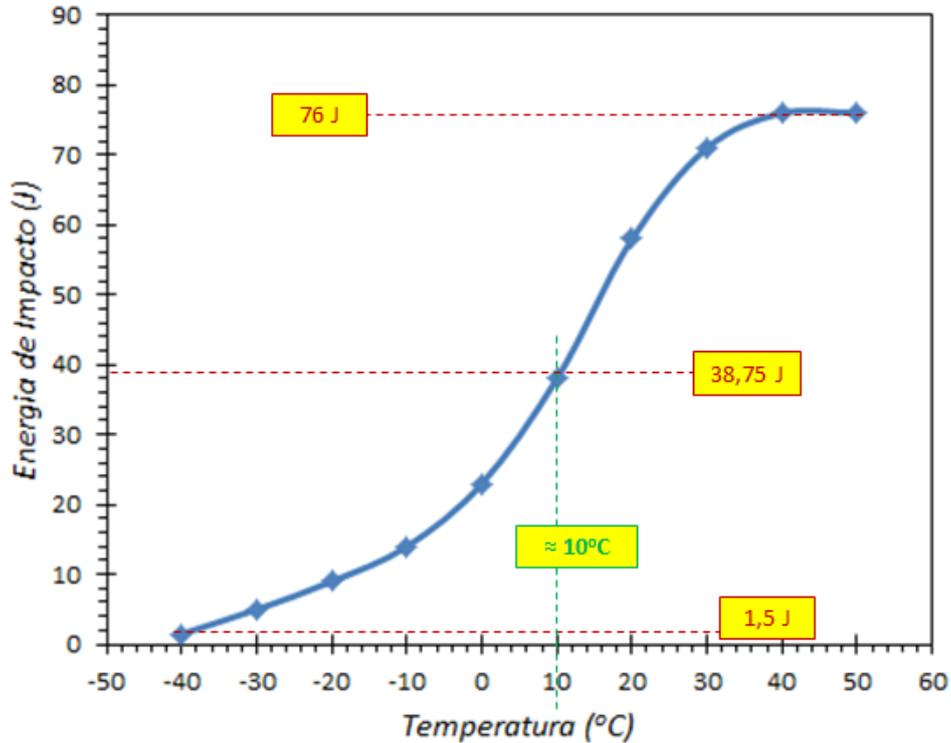
No gráfico encontra-se indicada a operação para a determinação do valor da temperatura de transição dúctil-frágil, que é de aproximadamente **10°C**.
