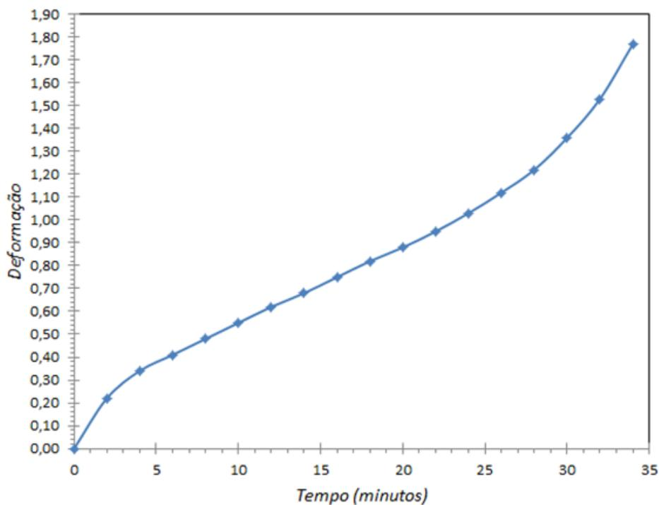
Determine a velocidade mínima de fluência (que equivale à velocidade do estado estacionário no ensaio de fluência). Nota: a deformação inicial (instantânea) não foi representada no gráfico.
