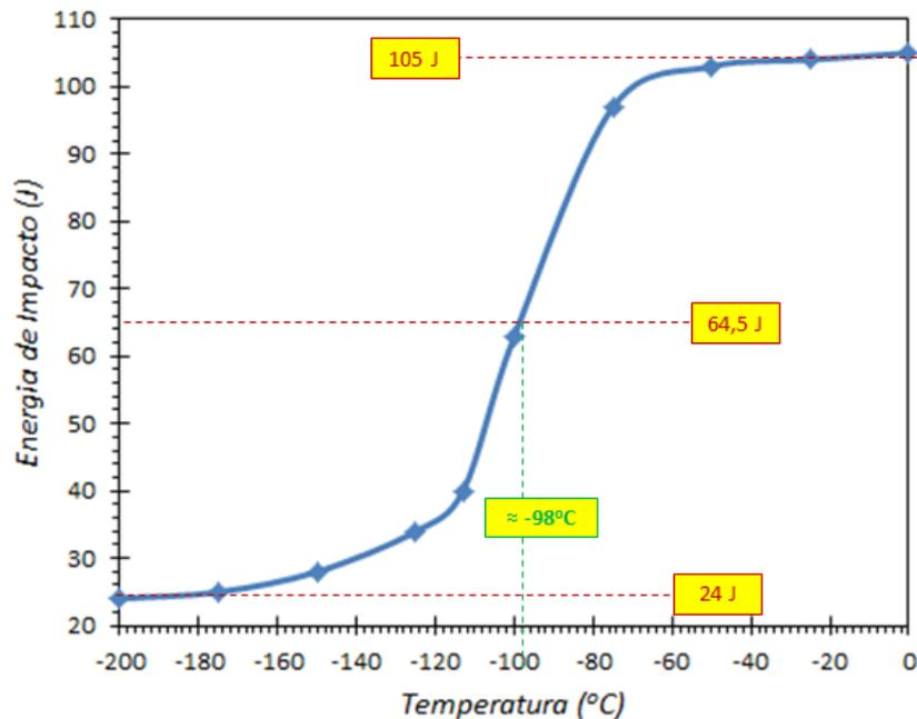
No gráfico encontra-se indicada a operação para a determinação do valor da temperatura de transição dúctil-frágil, que é de aproximadamente **-98°C**.
