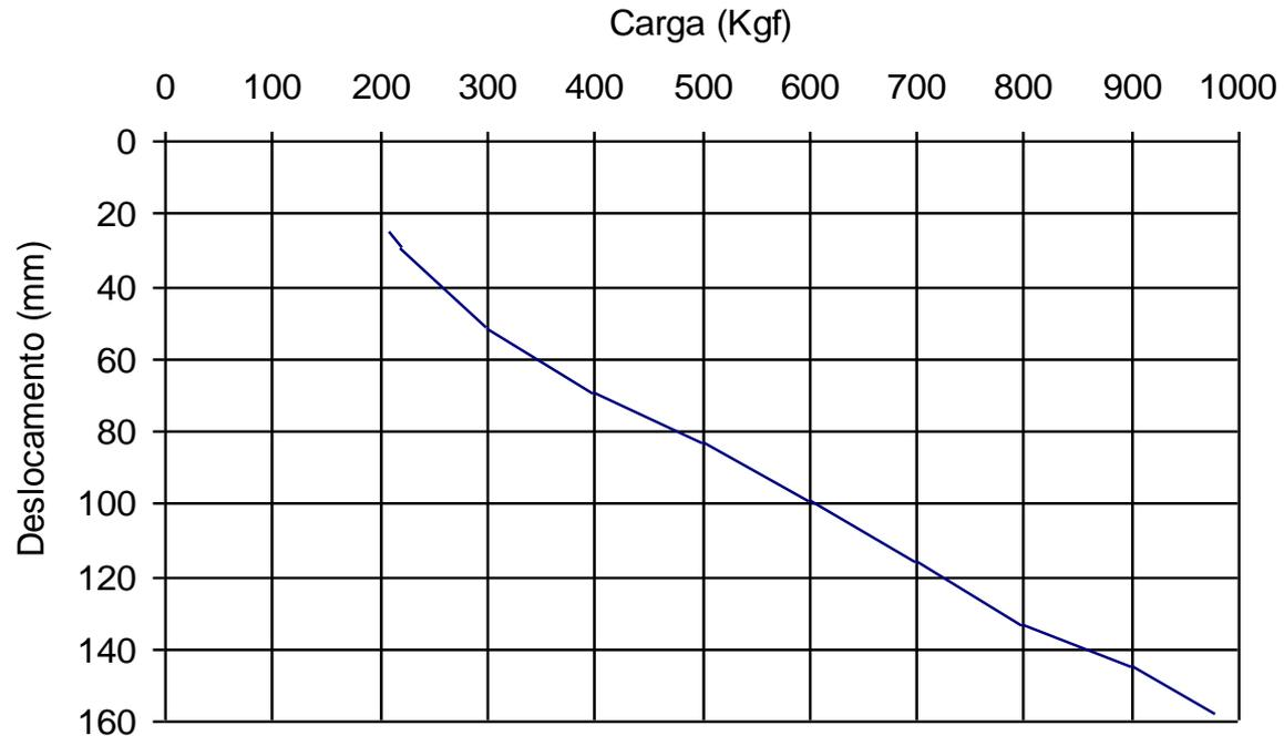
Carga vertical em função do deslocamento vertical em prova de carga realizada em lisímetro de grandes dimensões (modificado de Azevedo et al. 2006).
