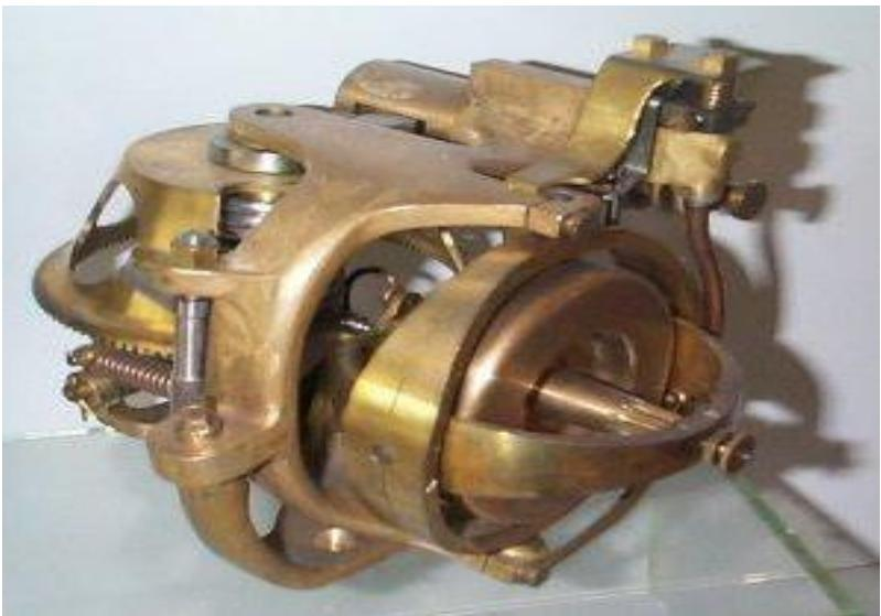
Giroscópio de um torpedo alemão.
