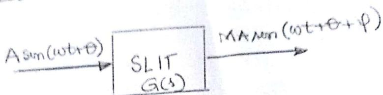
A onda senoidal é escolhida uma vez que, pela teoria de Fourier, sabe-se que qualquer sinal que entre no sistema pode ser representado por uma soma, geralmente infinita, de ondas periódicas com diferentes freqüências e amplitudes.
