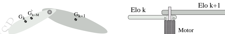
Figura 12: Aplicação de torque por um motor fixo ao elo k e conectado por eixo ao elo k+1.
