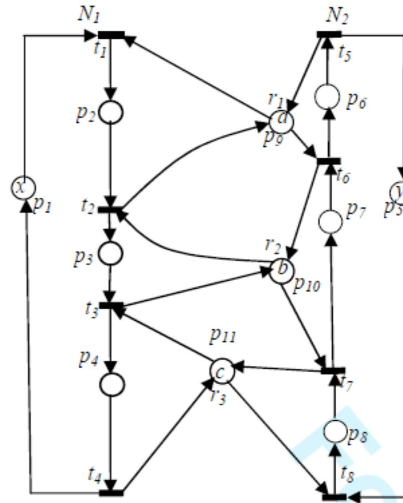
Fig. 1(a) S<sup>3</sup>PR & 3<sup>rd</sup>-order system ;
