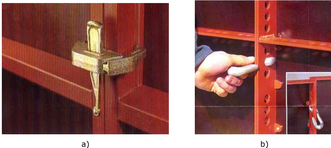
Figura 2.32 – Conectores para painéis: a) grampo (Meva, s.d.); b) clip (Peri, s.d.).
