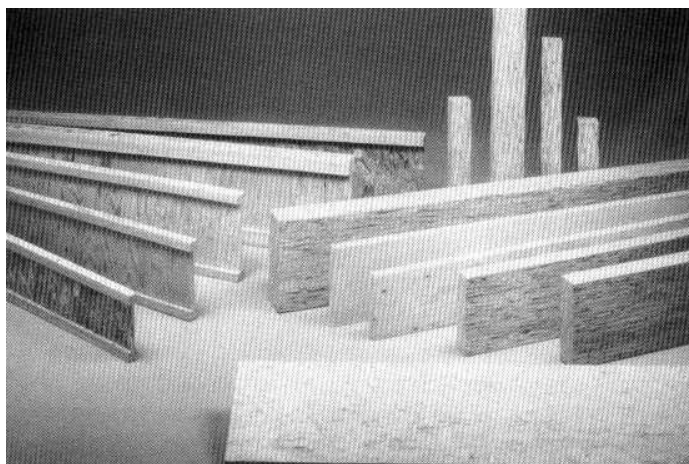
Figura 2.24 – Peças de madeira para suporte do molde (HURD, 1995).
