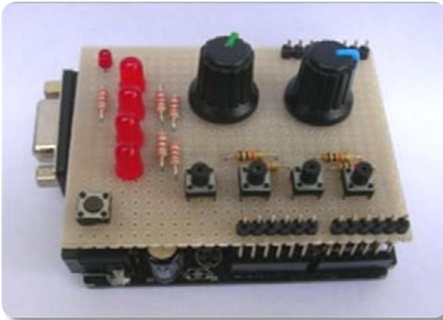
Figura 55: Módulo de E/S montado
