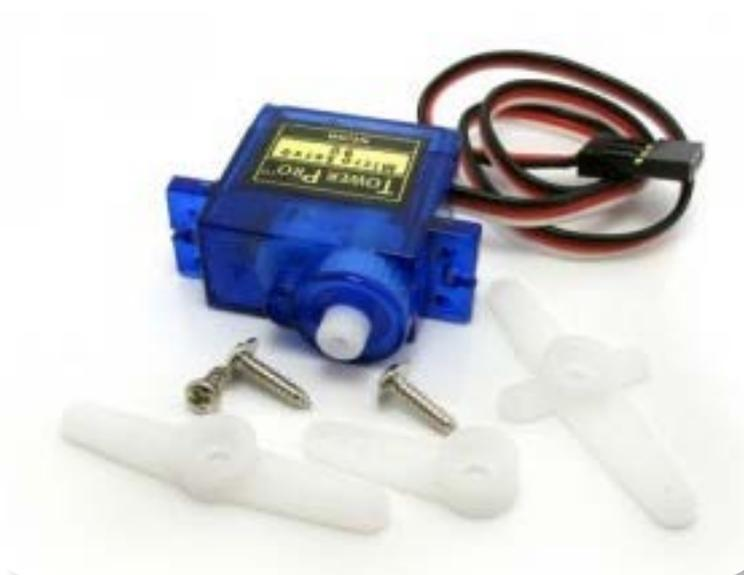
*Figura 20: Servo-motor*
