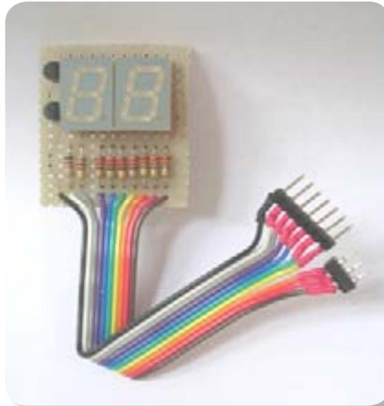
*Figura 32: Montagem do contador de 2 dígitos*
