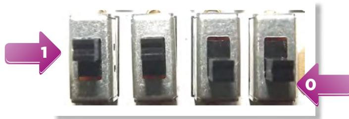
FIGURA 10 - CHAVES DO TIPO SLIDE SWITCH E RELAÇÃO ENTRE POSIÇÃO E NÍVEL LÓGICO
